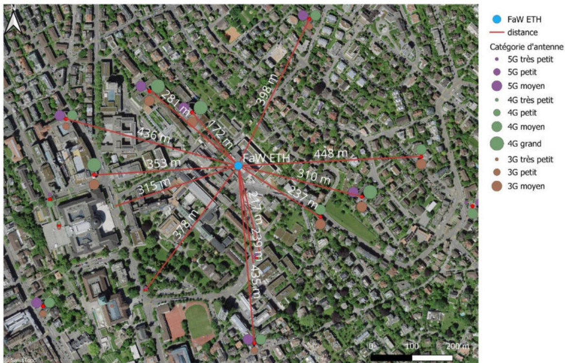
Figure 47: Emplacements des antennes de téléphonie mobile dans les environs immédiats de la station de mesure permanente de Zürich, classés selon la norme de téléphonie mobile et la puissance d'émission [21]. Les lignes de distance rouges doivent être considérées comme les distances horizontales les plus courtes entre l'antenne et le capteur d'intensité de champ. Les différences de hauteur ne sont pas prises en compte. En l'absence d'informations sur l'orientation azimutale des secteurs d'antennes, il est impossible d'estimer la contribution des différentes antennes.
