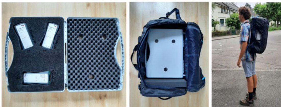
Figure 2: Représentation du setup pour les mesures d'itinéraires. À gauche : Trois appareils de mesure (deux ExpoM-RF4 et un ExpoM-ELF) sont fixés dans une valise remplie de mousse synthétique. Centre : La valise est placée dans le sac à dos et fixée avec de la mousse synthétique. À droite : le technicien porte le sac à dos contenant les appareils de mesure à une distance de 20 cm de son corps et à une hauteur de 160 cm.
