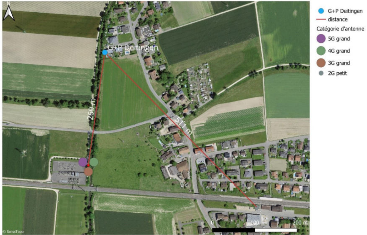
Figure 44: Emplacements des antennes de téléphonie mobile dans les environs immédiats de la station de mesure permanente de Deitingen, classés selon la norme de téléphonie mobile et la puissance d'émission [21]. Les lignes de distance rouges doivent être considérées comme les distances horizontales les plus courtes entre l'antenne et le capteur d'intensité de champ. Les différences de hauteur ne sont pas prises en compte. En l'absence d'informations sur l'orientation azimutale des secteurs d'antennes, il est impossible d'estimer la contribution des différentes antennes.
